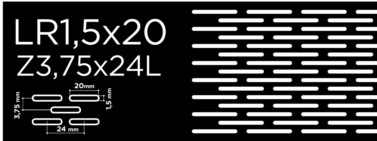
Tablă perforată cu găuri alungite dispuse alternativ - suprafața liberă 32,8%
