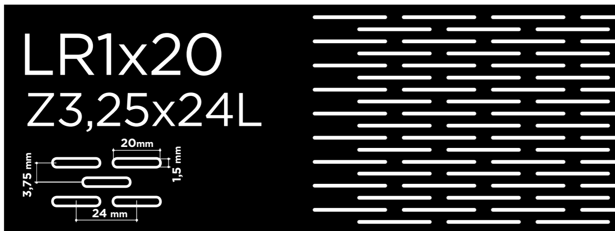
Tablă perforată cu găuri alungite dispuse alternativ - suprafața liberă 25,37%
